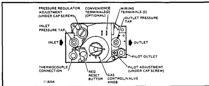
FIG. 17 - VR8204A/VR8304M AUTOMATIC GAS VALVE
