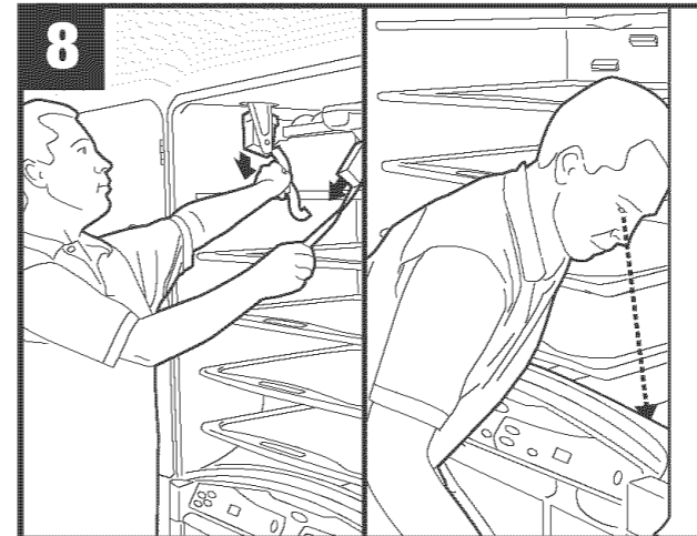
Remove tape and packing materials from shaker bar and check for packing materials in lower drum cavity./Enlevez le ruban adhésif et les matériaux d'emballage de la barre de mélange et vérifiez qu'il n'y a pas de matériaux d'emballage dans le tambour inférieur./Retire la cinta adhesiva y los materiales de empaque de la barra sacudidora y verifique si hay materiales de empaque en la cavidad del tambor inferior.
