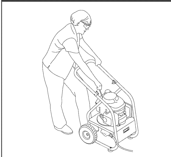
Figura 36 - Posición Recomendada para Poner en Marcha el Motor
