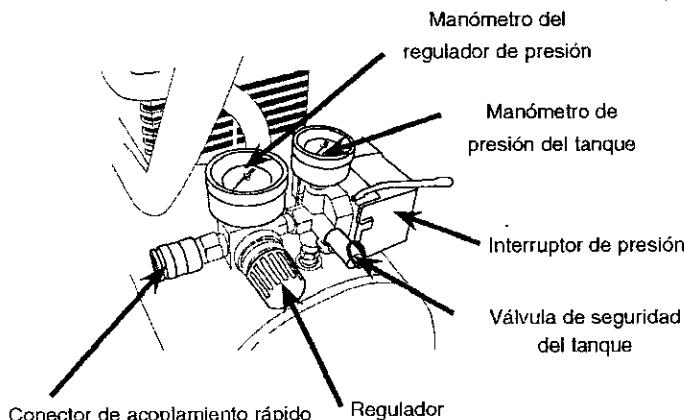
**Presión de arranque:** El compresor arranca automáticamente cuando la presión baje a menos del mínimo prescrito.
