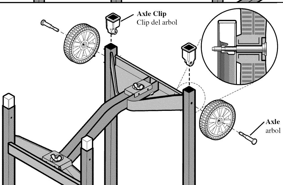
**Install Axle Clip Into Leg. ORIENTATION MUST BE AS SHOWN.**
