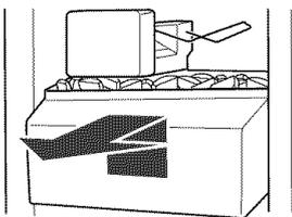
4. Replacer le bac à glaçons en le poussant complètement sinon le distributeur ne fonctionnera pas. Appuyer sur le bras d'arrêt en broche pour l'abaisser à la position ON pour remettre la production de glaçons en marche. S'assurer que la porte est bien fermée.
