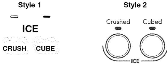
Pour de la glace concassée, les glaçons sont concassés avant d'être distribués. Cette action peut causer un court délai lors de la distribution de glace concassée. Le bruit du broyeur de glaçons est normal et la dimension des morceaux de glace peut varier. Lorsqu'on change de concassée à cube, quelques onces de glace concassée seront distribuées avec les premiers glaçons.
