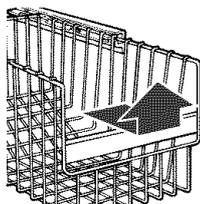
3. Replacer le panier ou bac en le plaçant sur les glissières de la paroi latérale. Soulever légèrement le devant du panier ou du bac en le poussant au-delà des butées de la glissière et le glisser jusqu'au fond.
