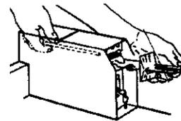
Pour une sécheuse dotée d'un mécanisme d'insertion à coulissement, utiliser l'ensemble d'adaptation fourni avec la sécheuse.
