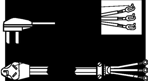
Le cordon d'alimentation à trois conducteurs doit comporter trois conducteurs de cuivre no 10, et on doit disposer d'une prise de courant à trois alvéoles de type NEMA 10-30R.
