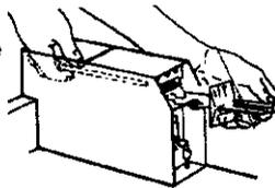
Pour une sècheuse dotée d'un mécanisme d'insertion à coulissement, utiliser l'ensemble d'adaptation fourni avec la sècheuse. Réinstaller la plaque de l'ouverture d'accès du boîtier de commande. Placer la boîte à pièces avec la serrure, et verrouiller.
