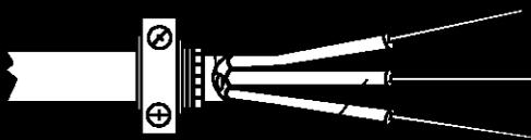
Enlever la gaine externe du câble sur 8,9 cm (3 1/2 po) à l'extrémité. Dénuder les conducteurs sur 2,5 cm (1 po). Pour un câble à 3 conducteurs plus conducteur de liaison à la terre, sectionner le conducteur de liaison à la terre à la limite de la gaine.
