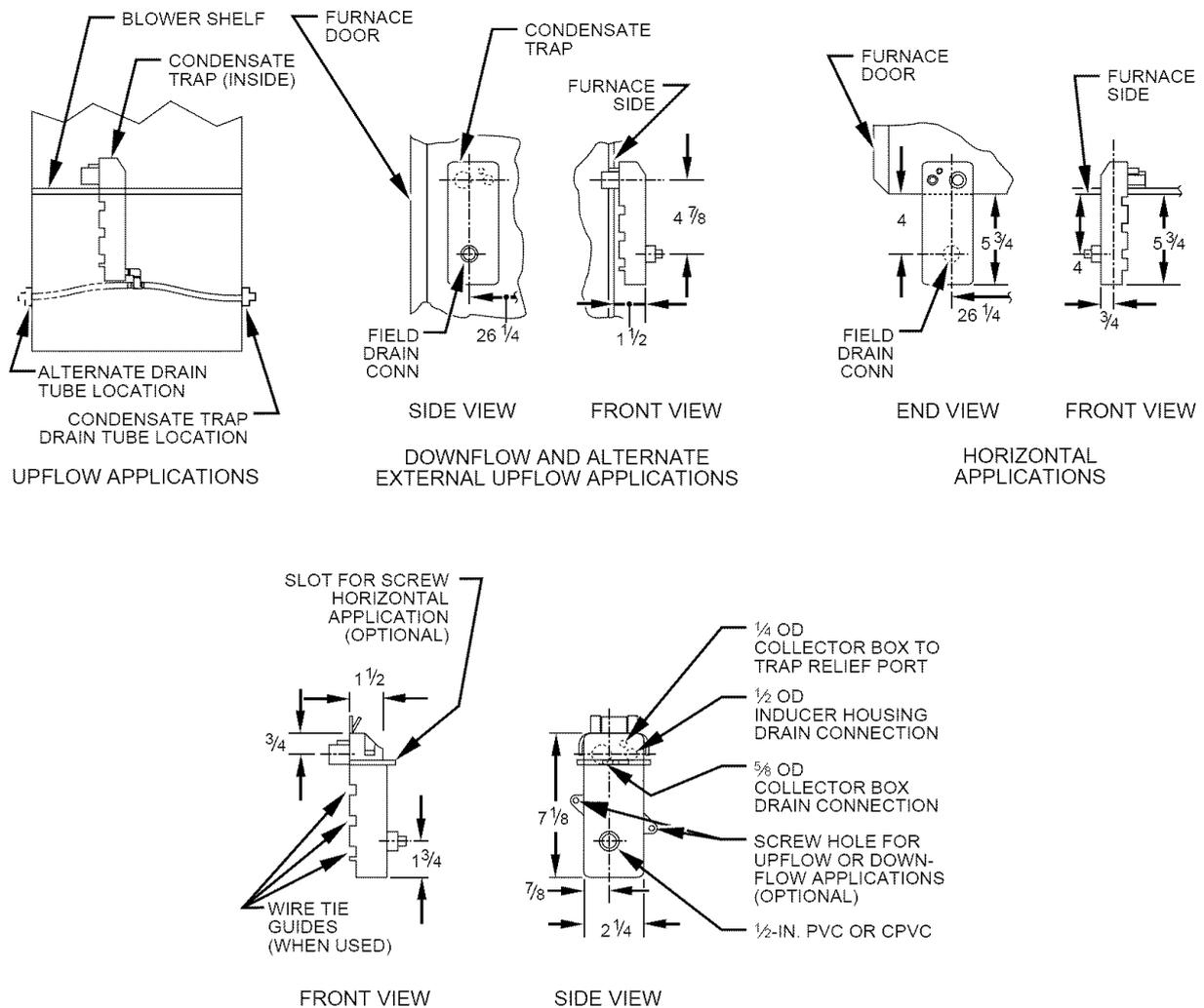
Fig. 5—Condensate Trap
