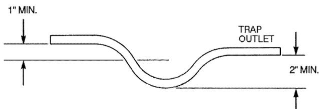
Fig. 10 — Condensate Trap
