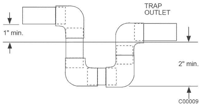
Fig. 8—Condensate Trap
