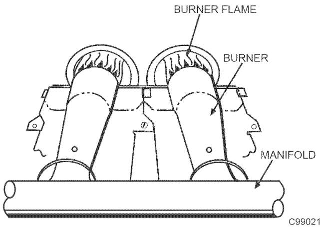
Fig. 14—Monoport Burner
