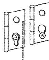
10. Enlever le bouchon d'obturation de la gâche de la porte (B). Insérer dans le trou la gâche qui a été enlevée à l'étape 8; fixer la gâche avec la vis. Insérer le bouchon d'obturation dans le trou d'où la gâche avait été initialement extraite; fixer le bouchon avec la vis.
