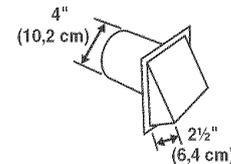
Consulter le tableau correspondant au type de clapet de décharge utilisé pour déterminer la longueur maximale de conduit utilisable.
