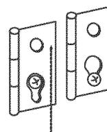
6. Fermer la porte et vérifier que la gâche de la porte est alignée avec le loquet (B) de la porte. Au besoin, déplacer la gâche de la porte vers la gauche ou la droite dans son logement pour ajuster l'alignement.
