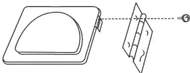
8. Enlever la gâche de la porte (E) de la caisse. Utiliser un petit tournevis à lame plate pour ôter soigneusement 4 bouchons d'obturation (F) du côté gauche de la caisse. Insérer les bouchons dans les trous de charnière du côté droit de la caisse.
