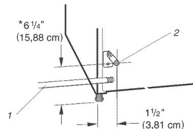
1. Canalisation d'arrivée de gaz NPT de 1/2 po
