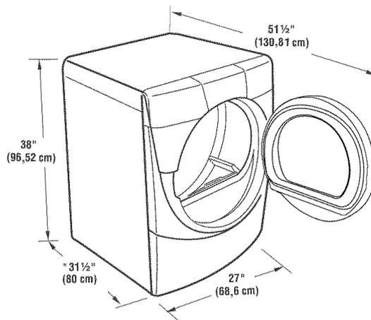
\* La plupart des installations requièrent un espace minimum de 5 1/2 po (14 cm) derrière la sécheuse pour le conduit d'évacuation avec coude. Voir "Exigences concernant l'évacuation".
