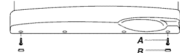
A. Vis de blocage de la poignée de la porte B. Bouchons obturateurs des vis de poignée de porte
