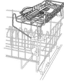
Le panier à ustensiles repose sur les deux supports du côté droit du panier inférieur. Charger le panier à même le lave-vaisselle ou le sortir pour le charger sur un comptoir ou une table.
