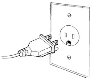
Enchufe el cable de alimentación en el tomacorriente puesto a tierra. Vuélva a conectar el suministro de energía.
