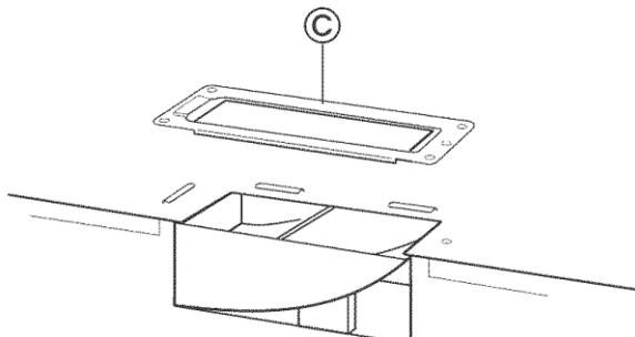
Deslice la placa de la compuerta **C** debajo de las lengüetas de retención. Guarde el tornillo para usarlo posteriormente.
