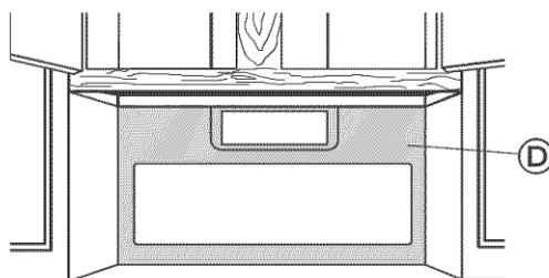
Coloque la placa de montaje (D) en la pared. Empuje los pernos acodillados (A) y las tuercas (C) a través del muro interior sin mortero (E).
