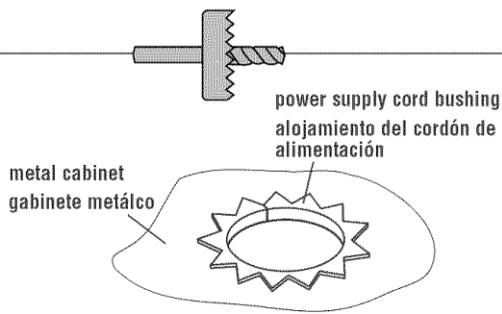
Use una broca de barrena o una sierra de calar para hacer un orificio de 2" de diámetro en el área sombreada marcada "M" en la plantilla del gabinete superior.
