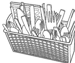
Placer les petits articles tels que les capuchons de biberons, couvercles de bocaux, porte-épi de maïs, etc. dans la section couverte. Fermer le couvercle pour maintenir les petits articles en place.
