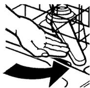
4. Ajouter le détergent à vaisselle et contrôler le niveau d'agent de rinçage dans le distributeur. Ajouter l'agent de rinçage au besoin. (Voir "Utilisation du lave-vaisselle".)
