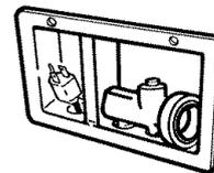
3. Tirer vers le bas sur le collet de blocage tout en poussant le raccord de tuyau sur l'adaptateur pour robinet.
