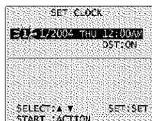
**b. Presione ▲▼ para seleccionar el mes y presione SET para ajustarlo. De la misma manera, seleccione y ajuste la fecha, año, hora, y DST (hora de verano).**
