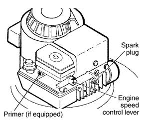
BRIGGS & STRATTON QUANTUM ENGINE MOUNTED SPEED CONTROL
