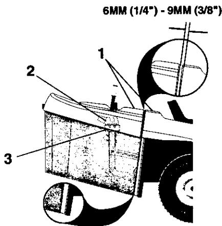
1. Le capotage du collecteur doit être aligné sur le capotage des ailes arrières du tracteur
