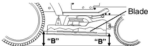
**BOTH FRONT PLATE LINKS MUST BE EQUAL IN LENGTH**
