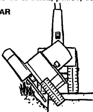
**BISELAR** - provee un corte más ancho o hace zanjas alrededor de aceras, caminos de entrada, patios, etc. Al biselar, usted removerá más material, por lo tanto incrementará la carga del motor. Sea cuidadoso y corte lentamente para evitar que el motor se sobrecargue o se cale, lo que puede dañar el motor.
