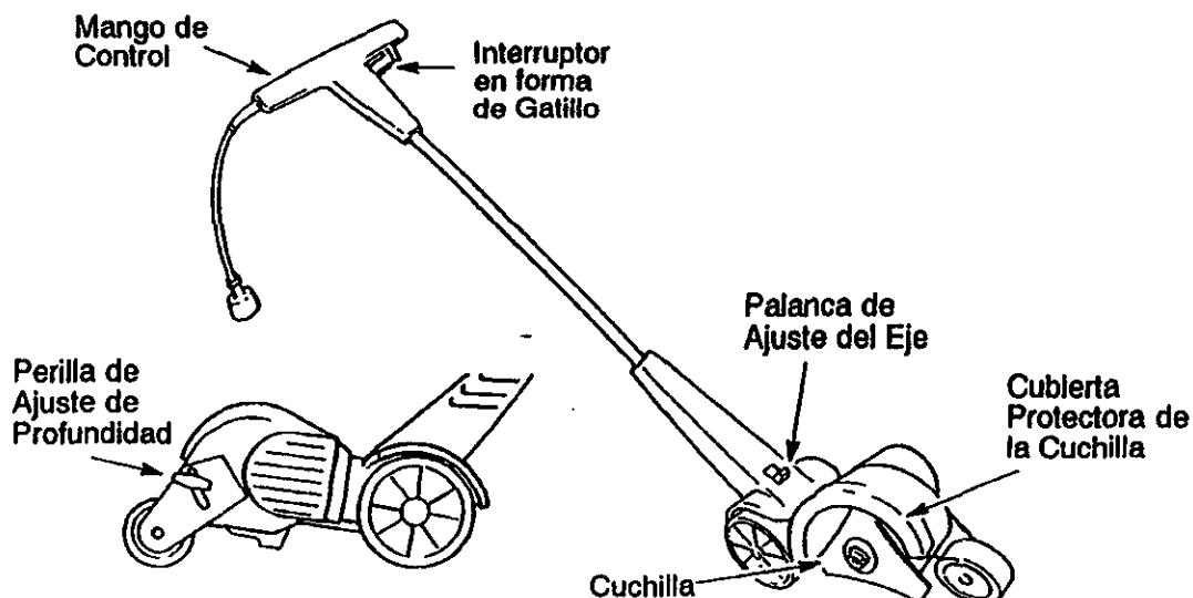
**EL INTERRUPTOR EN FORMA DE GATILLO** es usado para activar el motor.
