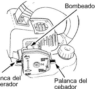
4. Firmemente, tire del mango de arranque hasta que el motor intente arrancar, pero no mas de 5 tirones.
