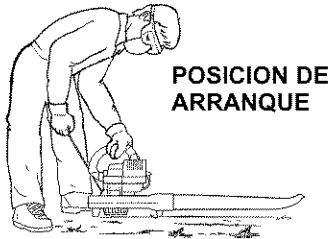
**ADVERTENCIA:** Al arrancar el motor, sostenga el aparato como se ilustra en la figura. Apoye el aparato exclusivamente en una superficie limpia y sólida siempre que vaya a efectuar el arranque y siempre que tenga que apoyar el aparato con el motor en marcha. Los escombros tales como la gravilla, la arena, la tierra, el césped, etc. pueden ser succionados por la entrada de aire y arrojados por la abertura de objetos o causando graves heridas a espectadores o al usuario.
