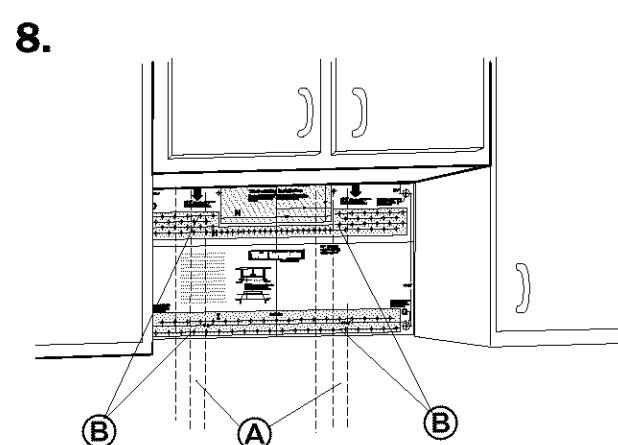
Verifique que los puntos "D" y "E", o "F" y "G" de la plantilla de pared estén sobre un montante de pared **A**: si los puntos están sobre un montante de pared, haga orificios de 3/16". Si los puntos están sobre un muro interior sin mortero, haga orificios de 3/4".
