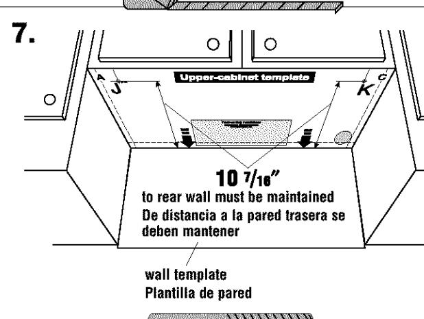
Coloque la plantilla de pared del gabinete superior contra la base del gabinete superior. Las flechas de la "Pared Trasera" deben estar contra la pared trasera de manera que los orificios hechos en la base del gabinete y los orificios en la parte superior del gabinete del horno microondas queden alineados.
