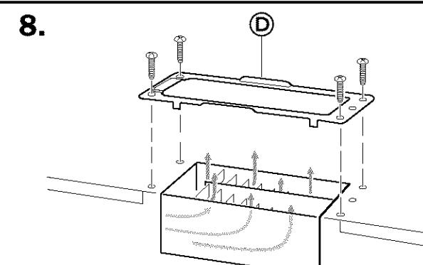
Vuelva a fijar la placa de la compuerta **D** con cuatro tornillos en cada esquina de la placa de la compuerta. Guarde el tornillo de roscado de colores brillantes para usarlo, posteriormente, para fijar el conjunto de la compuerta.
