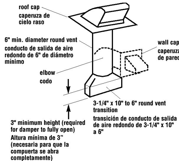
**Para métodos de salida de aire a través de la pared o el cielo raso:**
