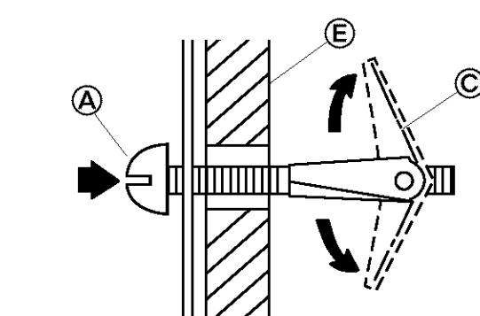
Coloque la placa de montaje **D** en la pared. Empuje los pernos acodillados **A** y las tuercas **C** a través del muro interior sin mortero **E**.
