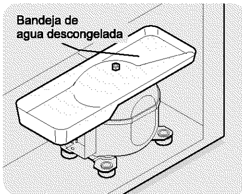
Bandeja de agua descongelada (en ciertos modelos)
