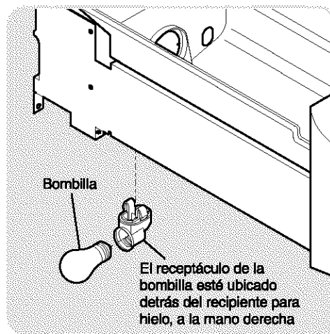
Reemplazo de la bombilla del congelador
