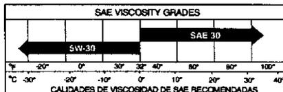
**AVISO:** A pesar de que los aceites de multiviscosidad (5W30, 10W30, etc.) mejoran el arranque en clima frío, estos aceites de multiviscosidad van a aumentar el consumo de aceite cuando se usan en temperaturas sobre 32° F. Revise el nivel del aceite del motor más a menudo, para evitar un posible daño en el motor, debido a que no tiene suficiente aceite.
