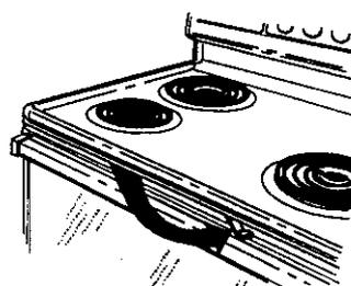
SLIDE DOOR LOCK/UNLOCK HANDLE TO THE RIGHT TO LOCK DOOR
