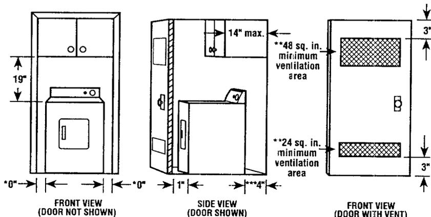
**MINIMUM INSTALLATION SPACING. CLOSET INSTALLATION MUST BE EXHAUSTED.**
