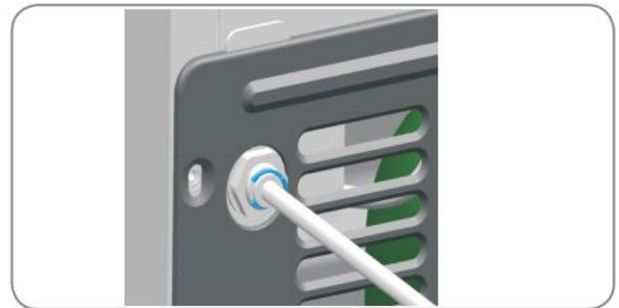
Paso 4) Instalar la abrazadera de seguridad.
