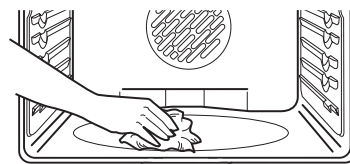
Limpie con un paño los desechos rebeldes acumulados en el piso del horno.
