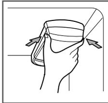
**REMARQUE :** Le remplacement du filtre à eau causera l'écoulement d'une petite quantité d'eau (env. 25 ml). Placez un verre sous la partie frontale du couvercle du filtre à eau pour recueillir les fuites éventuelles. Maintenez le filtre en position verticale une fois retiré pour éviter que l'eau restante ne s'écoule.
