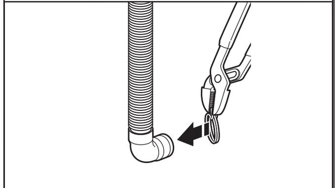
Si la abrazadera no está en su lugar, sobre el extremo del codo de la manguera de desagüe, deslícelo sobre el extremo como se muestra. Apriete la abrazadera con unas pinzas y deslice el extremo de la manguera de desagüe con el codo negro sobre el puerto de desagüe negro. Asegúrelo con la abrazadera.
