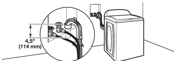
Vea los requisitos para el sistema de desagüe de tubo vertical de piso.
