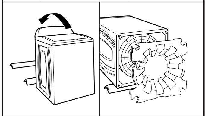
Para evitar dañar el piso, coloque los soportes de cartón de la caja de embalaje sobre el piso detrás de la lavadora. Incline hacia atrás la lavadora y colóquela sobre los soportes de cartón. Quite la base de embalaje rotando la base 90° hacia la derecha. Coloque la lavadora en posición vertical.
