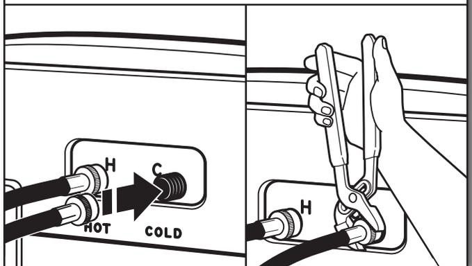
Sujete la manguera de agua caliente a la válvula de entrada del agua caliente, marcada con un anillo rojo. Atornille el acoplamiento a mano hasta que quede apretado. Use pinzas para apretar los acoplamientos dos tercios de vuelta adicional. Repítalo con la válvula de entrada del agua fría.
