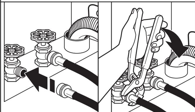
Cerciórese de que las arandelas planas estén en ambos extremos de las mangueras de entrada. Sujete la manguera al grifo de agua caliente. Atornille el acoplamiento con la mano hasta que quede asentado en la lavadora. Use pinzas para apretar los acoplamientos dos tercios de vuelta adicional. Repita este paso con la segunda manguera para el grifo de agua fría.
