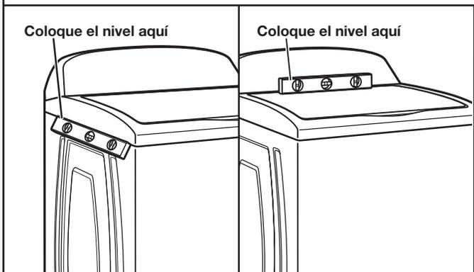
Con la lavadora en su ubicación final, coloque un nivel en los bordes superiores de la lavadora. Use la hendidura lateral como una guía para revisar la nivelación de los lados. Revise la nivelación del frente usando la tapa, como se muestra. Balancee la lavadora hacia delante y hacia atrás para asegurarse de que las 4 patas hagan contacto firme con el piso. Si la lavadora está nivelada, saltee al paso 15.
