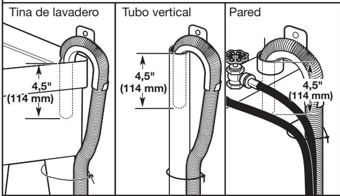
Asegure la manguera de desagüe a la pata del lavadero, al tubo vertical o a las mangueras de entrada para el tubo vertical de pared, utilizando el fleje de atadura rebordeado. Esto contribuirá a reducir la posibilidad de que se salpique agua del desagüe en el piso.
