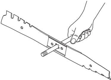
**IMPORTANT!** Les lames doivent être équilibrées après l'affûtage. Nous ne recommandons pas d'affûter la lame. L'affûtage et l'équilibrage de la lame doivent être effectués par un atelier agréé.
