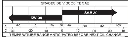
**MISE EN GARDE!** Bien que les huiles multigrades (5W30, 10W30, etc.) améliorent le démarrage par temps froid, elles occasionnent l'augmentation de la consommation d'huile lorsqu'on les utilise à une température supérieure à 0°C. Vérifier le niveau d'huile moteur plus fréquemment pour éviter d'éventuels dommages par manque d'huile.
