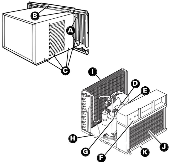
7. Envuelva el motor del ventilador (D), los terminales del capacitor (E), la caja de control eléctrico (F), y los terminales del compresor (G) en un material plástico y asegúrese de que no caiga agua ni ningún otro líquido dentro de estos elementos. Esto podría dañar el acondicionador de aire.
