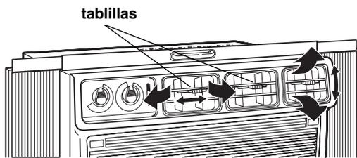
Las rejillas en la parte superior del panel delantero, controlan la dirección del aire enfriado. Use las tablillas para dirigir el aire hacia la derecha, o hacia la izquierda (en algunos modelos). Gire el cartucho completo para dirigir el aire hacia arriba, hacia abajo.
