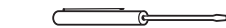
Destornillador plano pequeño (2 a 2.4 mm o 3/32" de tamaño de punta, 60 mm de largo)
