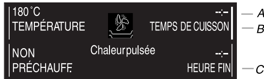
A. Durée de cuisson B. Zone de durée de cuisson C. Heure de fin de cuisson
