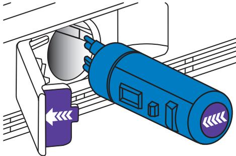
3. Retirer le filtre neuf de son emballage, puis retirer les protections des anneaux d'étanchéité. S'assurer que les anneaux d'étanchéité sont toujours en place une fois que les protections sont retirées.
