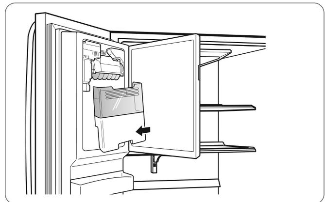
4. Evite tocar el apagado automático (brazo palpador) al colocar el recipiente del hielo. Consulte la etiqueta que hay en la puerta del compartimiento de hielo para obtener información más detallada.
