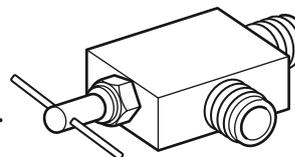
**NOTA:** No se debe usar una válvula de agua de tipo de montura autoperforante.
