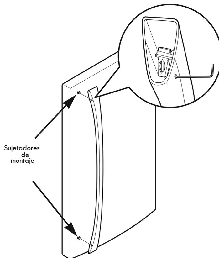
**NOTA:** Siempre se recomienda desmontar las puertas cuando sea necesario desplazar el refrigerador a través de un espacio estrecho. Si es necesario desmontar las manijas, siga las instrucciones que se indican a continuación.
