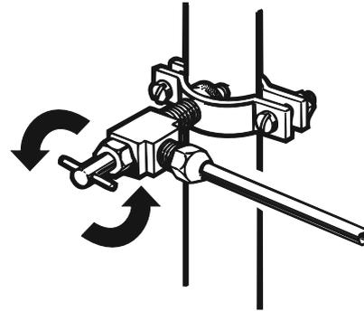
**! PRECAUCIÓN:** Compruebe si hay fugas en las conexiones de las tuberías de agua.
