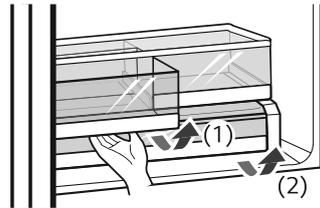
2. Para instalar, incline el frente levemente hacia arriba, inserte el cajón para verduras o estante en el marco y empujelo hacia atrás en su lugar.
