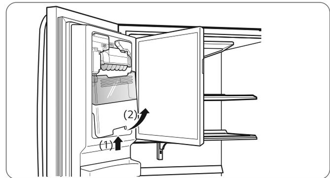
3. Para volver a instalar el depósito de hielo del interior de la puerta, incline ligeramente el depósito al volver a colocarlo en su sitio para evitar el contacto con la máquina de hielo.
