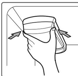
**NOTA:** Al reemplazar el filtro de agua se drena una pequeña cantidad de agua (unos 25 cc). Colocar un paño alrededor de la parte delantera de la tapa del filtro de agua para recoger el agua que se escape. Sostenga el filtro de agua en posición vertical, una vez retirado, para evitar que el agua residual se salga del filtro de agua.
