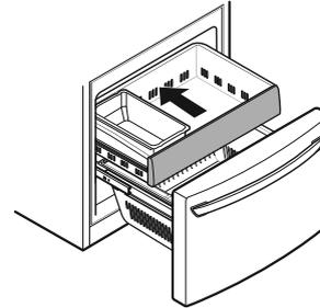
Vuelva a colocar el recipiente de hielo en el estante. Introduzca la canasta Durabase en el montaje del riel.
