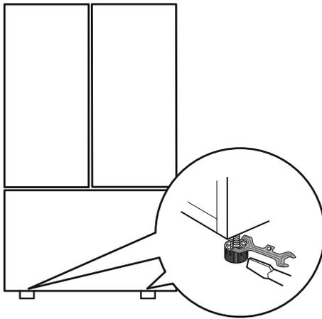
**NOTA:** Si una persona empuja hacia atrás la parte superior del refrigerador, descargará parte del peso de los pies de nivelación. Esta operación facilitará el ajuste de los pies.
