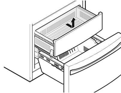
2. Para instalar, incline hacia arriba ligeramente el frente e inserte el cajón en el bastidor y empuje hacia atrás para que quede en su lugar.
