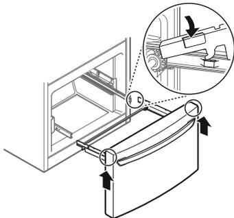
Baje la puerta a su posición final y asegure los tornillos localizados en ambos lados.
