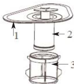
1) **FILTRE PRINCIPAL:** Les particules de nourriture et les saletés captées par ce filtre sont pulvérisés par un jet spécial situé sur le bras gicleur inférieur et sont acheminés dans le drain.
