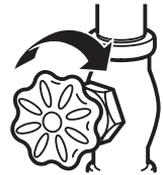
9 CONNECT THE TUBING TO THE REFRIGERATOR
