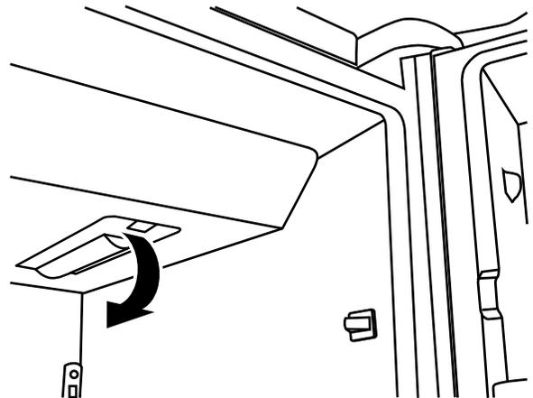
4. Aligner l'arête sur l'étiquette du filtre à eau avec l'encoche du logement du filtre et insérer le filtre dans le logement.
