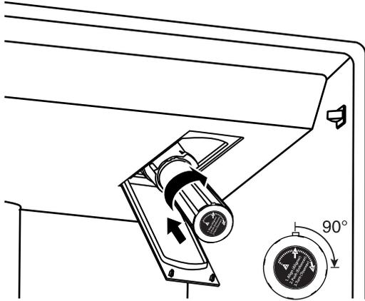
6. Alors que la porte du compartiment est toujours ouverte, soulever le filtre dans le compartiment. Puis, fermer complètement la porte du compartiment du filtre.
