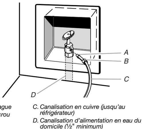
4. On est maintenant prêt à connecter le tuyau en cuivre au robinet d'arrêt. Utiliser un conduit de cuivre flexible de  $\frac{1}{4}$ " (6,35 mm) de diamètre extérieur pour raccorder le robinet d'arrêt au réfrigérateur.
