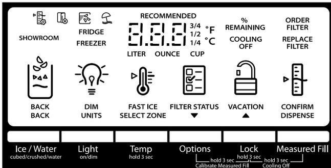
**IMPORTANT :** L'écran d'affichage sur le tableau de commande du distributeur s'éteint automatiquement et entre au mode "veille" lorsque les boutons de commande et les leviers du distributeur n'ont pas été utilisés pendant au moins 2 minutes. Appuyer sur n'importe quel bouton de commande pour réactiver l'écran d'affichage. L'écran d'accueil apparaît tel qu'indiqué.
