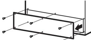
Retire la tapa flexible de plástico de la válvula del agua (conexión del refrigerador).
