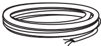
2 cables de 120V 60Hz. 15 o 20 Amp, con conexión a tierra. Circuito de empalmes correctamente instalado a tierra.
