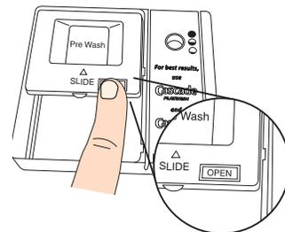
Verser le détergent sélectionné dans le distributeur. Placer son doigt comme illustré et faire glisser la porte pour la fermer. Appuyer fermement jusqu'à ce qu'un déclic se fasse entendre.
