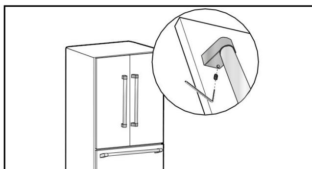
4. Repita los pasos 2 y 3 para fijar el tornillo de fijación inferior.
