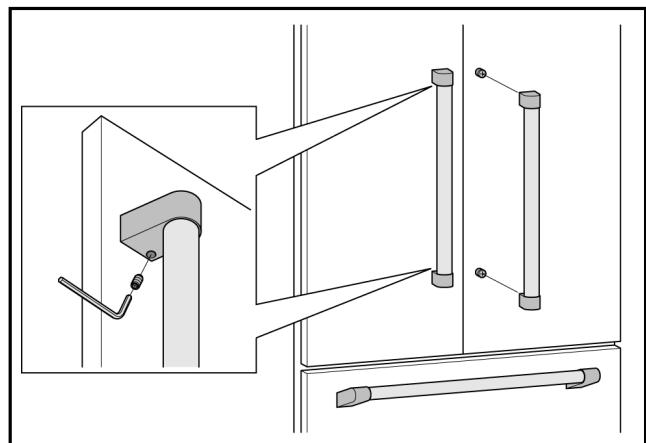
2. Afloje el tornillo de fijación girándolo hacia la izquierda un cuarto de vuelta cada vez. Repita el proceso para cada tornillo de fijación.
