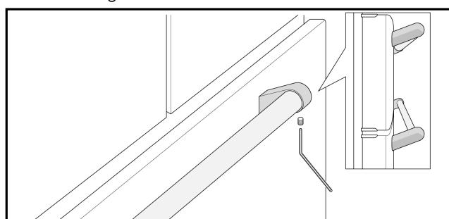
9. Una vez que ambos tornillos de fijación se hayan apretado parcialmente como se indica en los pasos anteriores, apriete ambos por completo.
