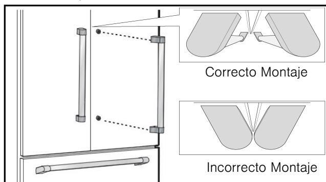
3. Mientras sujetá la manija, inserte el lado corto de la llave Allen en el tornillo de fijación. Apriete el tornillo de fijación con un movimiento hacia la derecha hasta que comience a entrar en contacto con el tornillo de resalto. No apriete completamente el tornillo.
