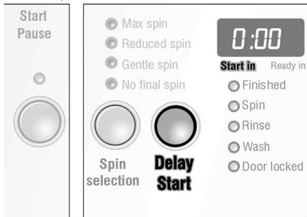
Presione este botón. El display indica "0:00". El tiempo de remojo puede extenderse hasta un máximo de 19 horas, en pasos de 1 hora, presionando las veces necesarias el botón **Delay Start**.
