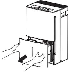
**IMPORTANTE:** No use el manguera si usa el tanque para recoger agua. Si el manguera está conectada, el agua caerá al piso en lugar de caer dentro del tanque.
