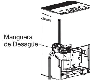
3. Enrosque una manguera para jardín (no provista) en la boquilla, cut to length, y diríjala al drenaje de piso.
