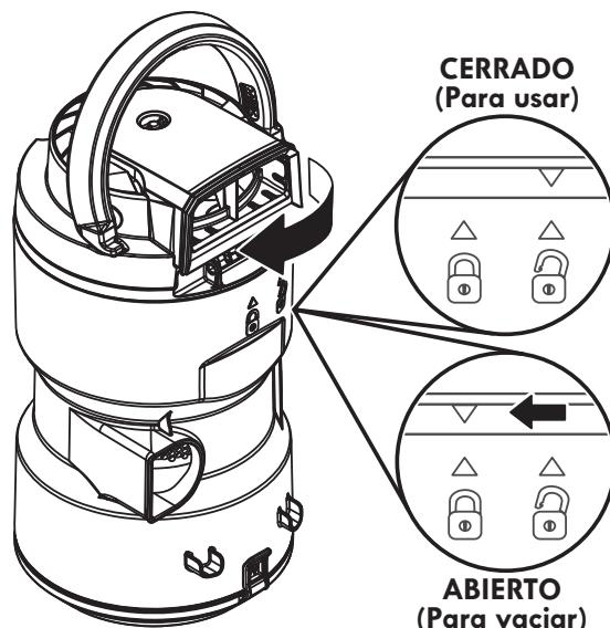
4. Gire mientras presiona hacia abajo hasta que las marcas queden alineadas como se muestra; **LOCKED** (para su uso).
