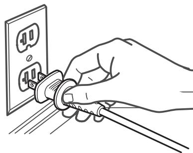
**NOTA:** Para reducir el riesgo de choque eléctrico, esta aspiradora cuenta con una clavija polarizada, uno de los contactos es más ancho que el otro. La clavija sólo puede introducirse de una manera en el enchufe. Si la clavija no cabe bien en el enchufe, invertirla. Si aún no cabe, llame a un electricista para que instale un enchufe correcto. No altere la clavija de ninguna manera.
