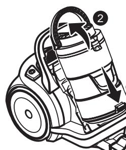
1. Colocar nuevamente el contenedor de polvo en la aspiradora, ① colocando primero la parte inferior e ② inclinándolo al ensamblar.
