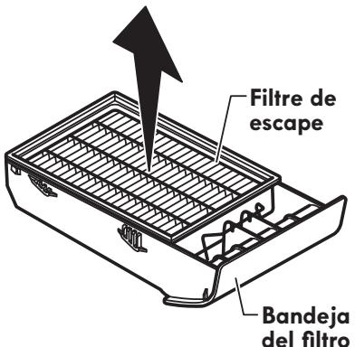
3. Reemplace el filtro de escape. Coloque un nuevo filtro de escape en la bandeja del filtro como se muestra.
