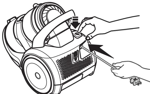
**Para enrollar:** Desconecte la aspiradora. Sujete el enchufe mientras enrolla el cordón para impedir daño o lesión corporal por el movimiento del cordón. Oprima el botón el para retractar el cordón eléctrico.
