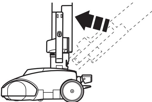
2. Pise el pedal de liberación rápida para tubo y tire del tubo hacia arriba para desprenderlo de la PowerMate®.
