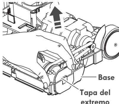
6. Examine y limpie las áreas de tapa del extremo. Vea la sección LIMPIEZA DEL AGITADOR y en ENSAMBLE DEL AGITADOR se proporciona una ilustración de todo el ensamble del agitador.
