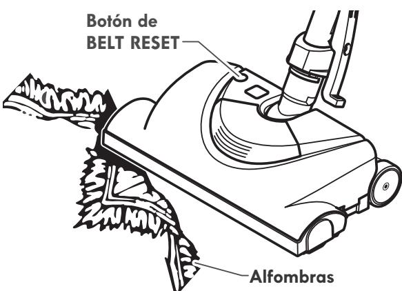
**Para corregir el problema:** Apague y desconecte la aspiradora, limpie la obstrucción, y después presione el botón de BELT RESET (protector de sobrecarga). Puede ser necesario un bolígrafo para presionar el botón.
