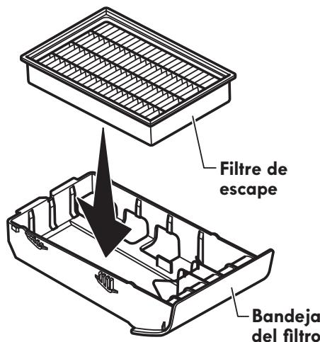
4. Vuelva a instalar la bandeja del filtro de escape. Presione hasta que encaje en su lugar.
