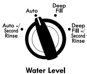
Ajuste la perilla del nivel de agua a la posición de Auto Sensing (detección automática) y la arandela se llenará hasta un nivel que asegure que la carga enganche el agitador. A partir de este punto, el control electrónico detectará la carga y determinará si se necesita agua adicional.
