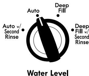
Régler le bouton de niveau d'eau sur Auto Sensing (détectio automatique) et la rondelle se remplira à un niveau qui garantit que la charge engage l'agitateur. À partir de ce point, la commande électronique détectera la charge et déterminera si de l'eau supplémentaire est nécessaire.
