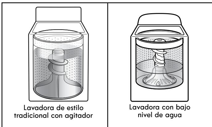
La lavadora regula automáticamente el nivel del agua de acuerdo al tamaño de la carga; no se necesita un selector de nivel de agua.
