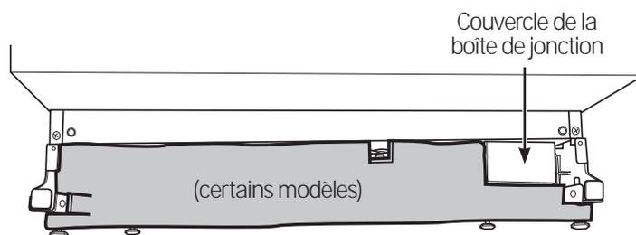
Le matériau insonorisant illustré est accolé au bord inférieur de la boîte de commande et à niveau avec le devant, disposé correctement le long de la partie inférieure du lave-vaisselle.
