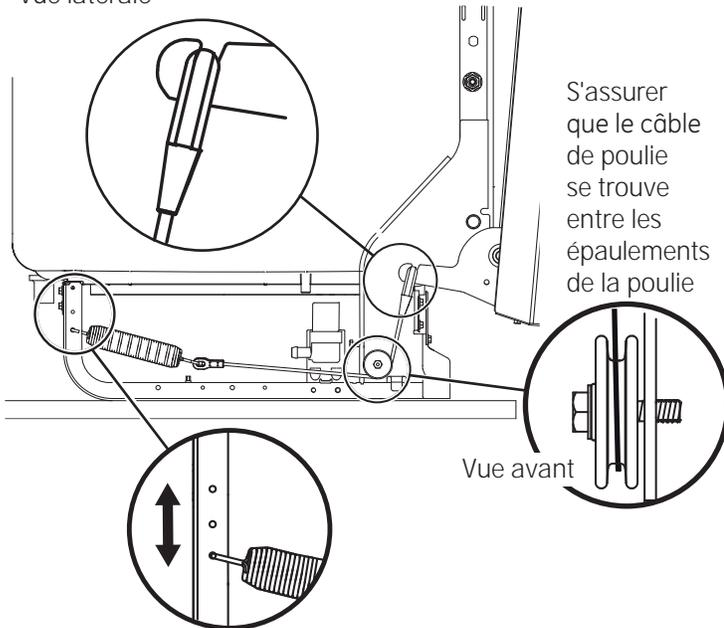
**Conseil:** Pour que la porte ouvre et se ferme facilement. Vérifiez la porte en l'ouvrant et en la fermant. Si elle n'ouvre pas facilement ou s'ouvre trop rapidement, vérifiez la disposition du câble du ressort. Le câble est retenu en place par des «épaulements» sur la poulie. Assurez-vous que le câble est bien installé sur les épaulements de la poulie comme indiqué.
