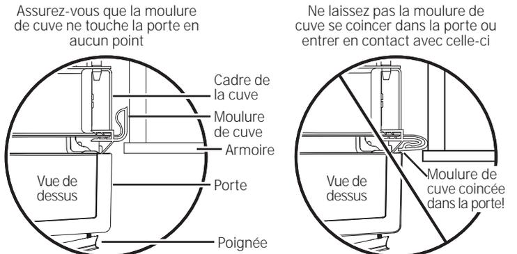
Si nécessaire, la moulure de cuve peut être rognée pour assurer le bon fonctionnement de la porte
